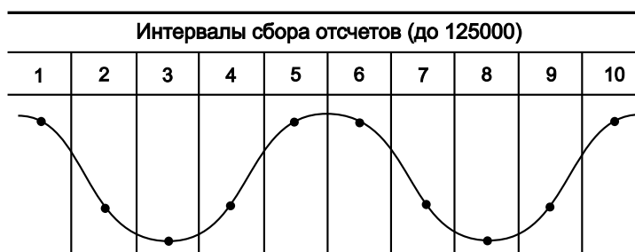
Рис. 8-17 Принцип формирования стандартных выборок
