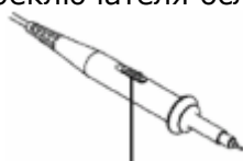
Рис. 7-5 Переключатель ослабления (по стрелке)
