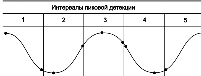
Рис. 8-18. Принцип формирования выборок пикового детектора
